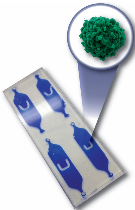
Abbildung 1: Organ-on-a-Chip System mit integrierten humanen Lebersphäroiden
